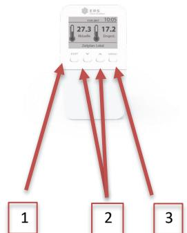
2. Pfeil nach unten, Pfeil nach oben - Aus der Position des Startbildschirms (Abb.3) verändern Sie mit den „Pfeil nach unten / nach oben“ Tasten die Solltemperatur. Sollte sich das Gerät bis dahin in einem Zeitplanmodus oder dem Modus einer zeitabhängigen Temperatureinstellung befinden haben, wechselt der Modus mit Betätigung einer dieser Tasten in den Modus „konstante Temperatur“.
